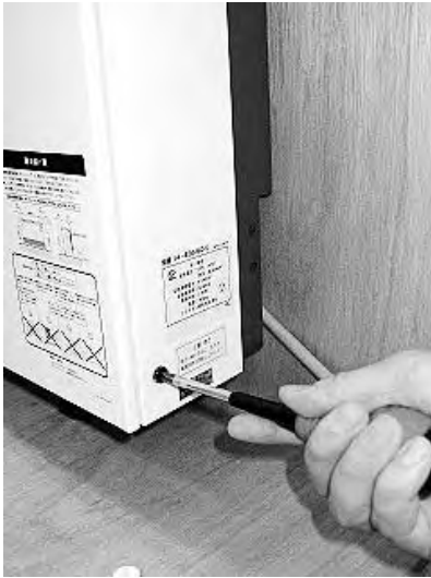
①両側面下部にあるビスキャップを外し、前面パネル固定ネジを外します。
