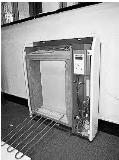
⑦ヒーターを上方に持ち上げると底部断熱材からヒーターが抜けますので、手前側に倒して下さい。
