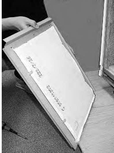
⑤インナーパネルの内側にはマイクロサーム断熱材が取り付けられておりますので、取り外しに注意下さい。
